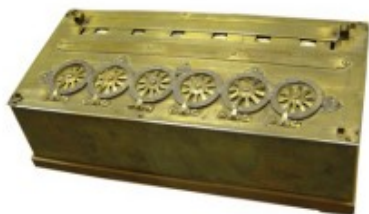
1642 : Pascal réalise une première machine mécanique permettant d'additionner ou de soustraire deux nombres
