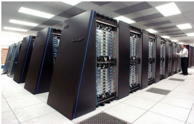
2004 : Supercalculateur IBM Blue fonctionne avec 250 000 processeurs utilisant un système de refroidissement standard par air
